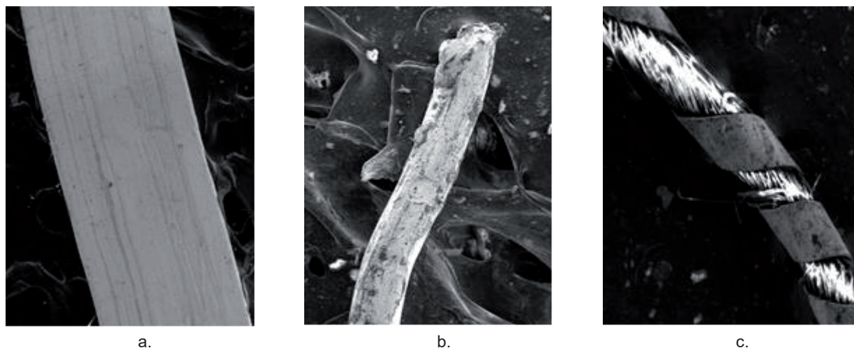
Slika 1: Tri različite metalne niti analizirane SEM-EDX-om: a. lamela; b. žica; c. srma
