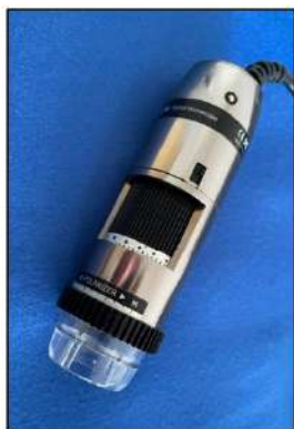
Slika 89 Digitalni mikroskop Dino-Lite AM7915MZT
