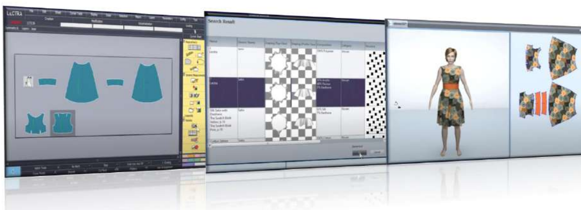
Slika 39 CAD sustav za 2D/3D projektiranje odjeće Lectra Modaris 3D [178]
