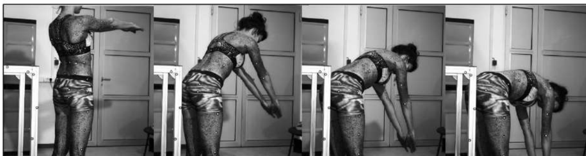
Slika 65 Snimanje pokreta primjenom Aramis sustava - KL 4, I1
