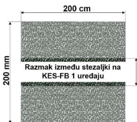
Slika 92 Dimenzije ispitnih uzorka za mjerenje KES sustavom
