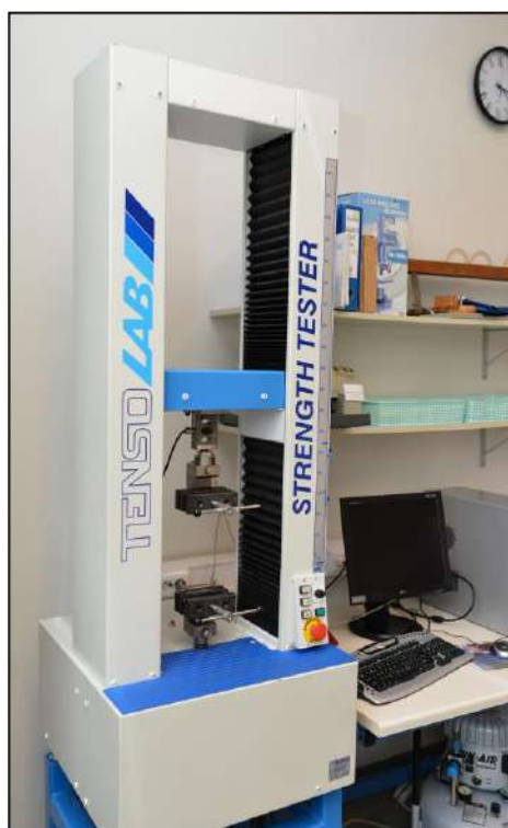
Slika 93 Kidalica Mesdan S.p.A., Tensolab 3000
