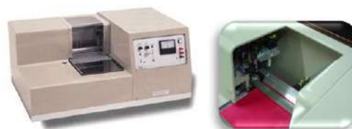
KES-FB2 AUTO mjerni sustav za savojna svojstva
