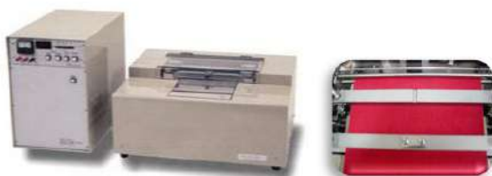
KES-FB1 AUTO mjerni sustav za vlačna i smična svojstva
