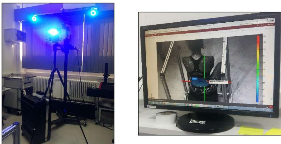
Slika 60 Aramis mjerni sustav
