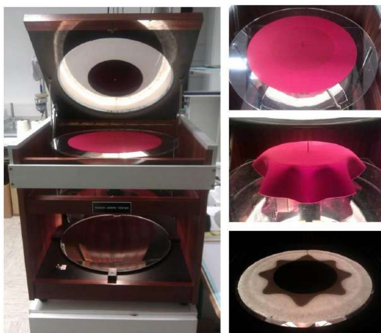
Slika 36 Cusick Drape Meter za ispitivanje drapiranja
