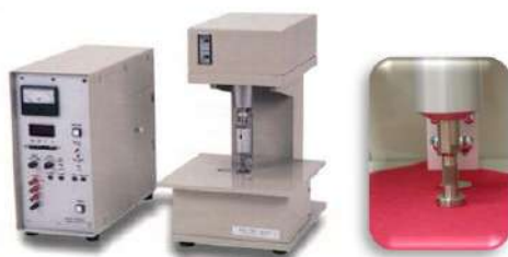
KES-FB3 AUTO mjerni sustav za kompresijska svojstva
