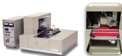
KES-FB4 AUTO mjerni sustav za površinska svojstva
