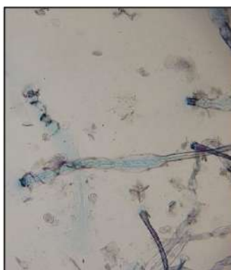
Slika 88 Identifikacija sirovinskog sastava materijala M2: a) osnova 100x, pamučna vlakna / kuoxam, b) potka 100x, elastanska vlakna / ClZnJ
