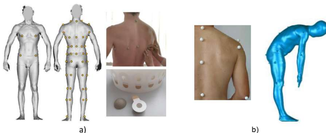
Slika 14 Pozicioniranje markera na tijelo ispitanika prema različitim autorima: a) Mahnić Naglić i Petrak [3], b) Morlock i suradnici [4]
