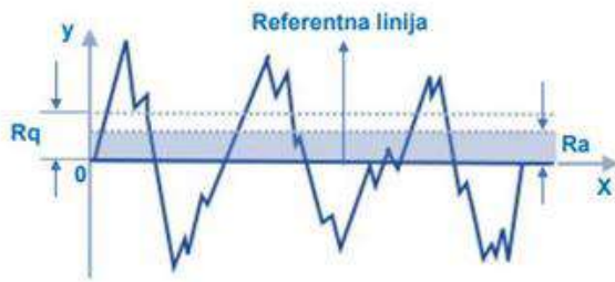
Slika 2: Profil hrapavosti i parametri hrapavosti
