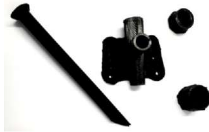
Slika 6: Prototip katetera dobiven metodom taložnog očvršćivanja
