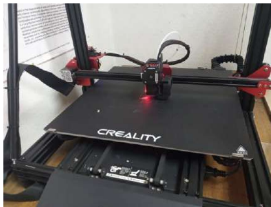
Slika 2: 3D printer Creality CR-10 max s prilagodljivom temperaturom podloge i mlaznice
