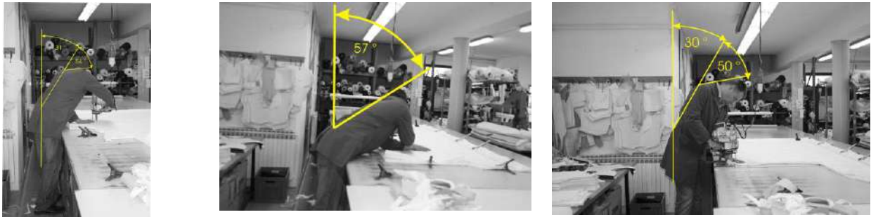
Slika 3: Prikaz karakterističnih radnih položaja kod iskrojavanja strojem s udarnim nožem (RM1)
