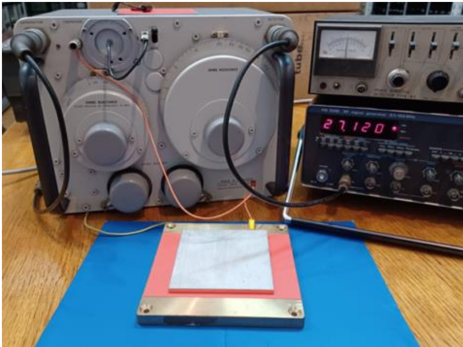
Slika 7. Mjerni postav i mjerna metoda za mjerenja dielektričkih gubitaka u tekstilnim materijalima [1]
