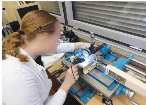
Slika 2. Mjerni uređaj za ispitivanje karakteristika spojeva nastalih ultrazvučnim i visokofrekventnim spajanjem polimernih materijala korišten u nastavi
