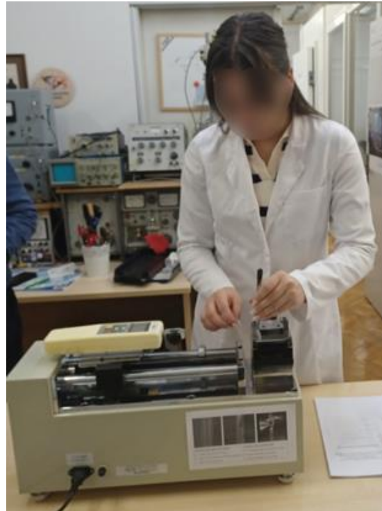
Slika 5. Određivanje prekidnih sila primjenom „T“ ispitne metode kidanja spojeva nastalih visokotehnoškim tehnikama spajanja
