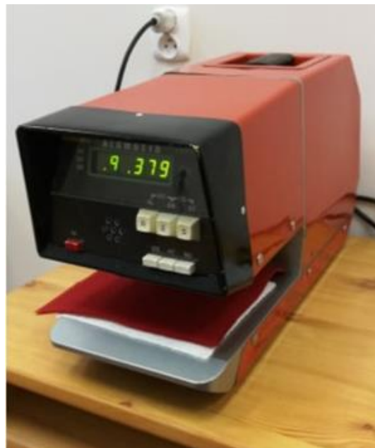
Sl. 10: Prikaz Alambeta mjernog uređaja (Kaziur et al., 2022)
