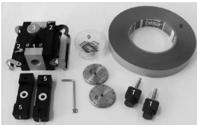
Slika 30. Podesiva ćelija za diskove, AGCD: 1) kućište sa silikonskim brtvenim blokom, 2) osovinica za paralelno namještanje držača uzorka, 3) gumb za kompresijski silikonski brtveni blok, 4) stezaljka vodilice za namještanje razmaka, 5) glava za namještanje razmaka, 6) matica za namještanje razmaka u ćeliji, 7) nosači uzorka, 8) dvostrana ljepljiva traka, 9) komplet odstojnika i 10) imbusni ključ [99]
