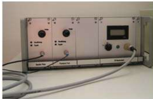
Slika 10: Mjerni uređaj sustava za mjerenje vertikalne sile pritiskne nožice šivaćeg stroja i probodne sile šivaće igle
