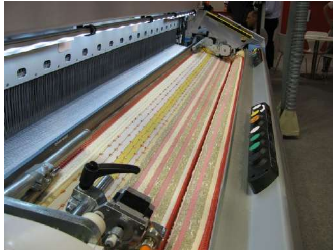
Slika 6: Tkalački stroj tt. Smit Textile s jednom krutom utkivnom šipkom za unos potke
