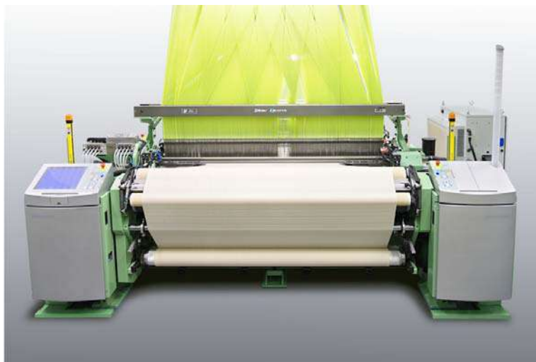
Slika 7: Žakardski tkalački stroj sa sklopom za odvojeno upravljanje žakardskim uređajem
