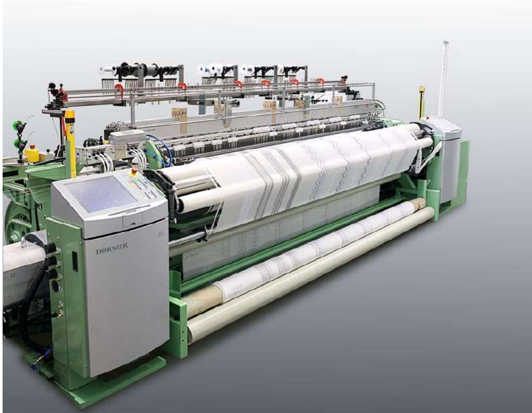
Slika 10: Tkalački stroj za izradu perlink veza s otvorenim brdom
