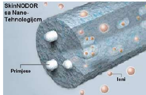
Slika 4: Presjek Skin NODOR®-a s primjesama i otpušajućim ionima
