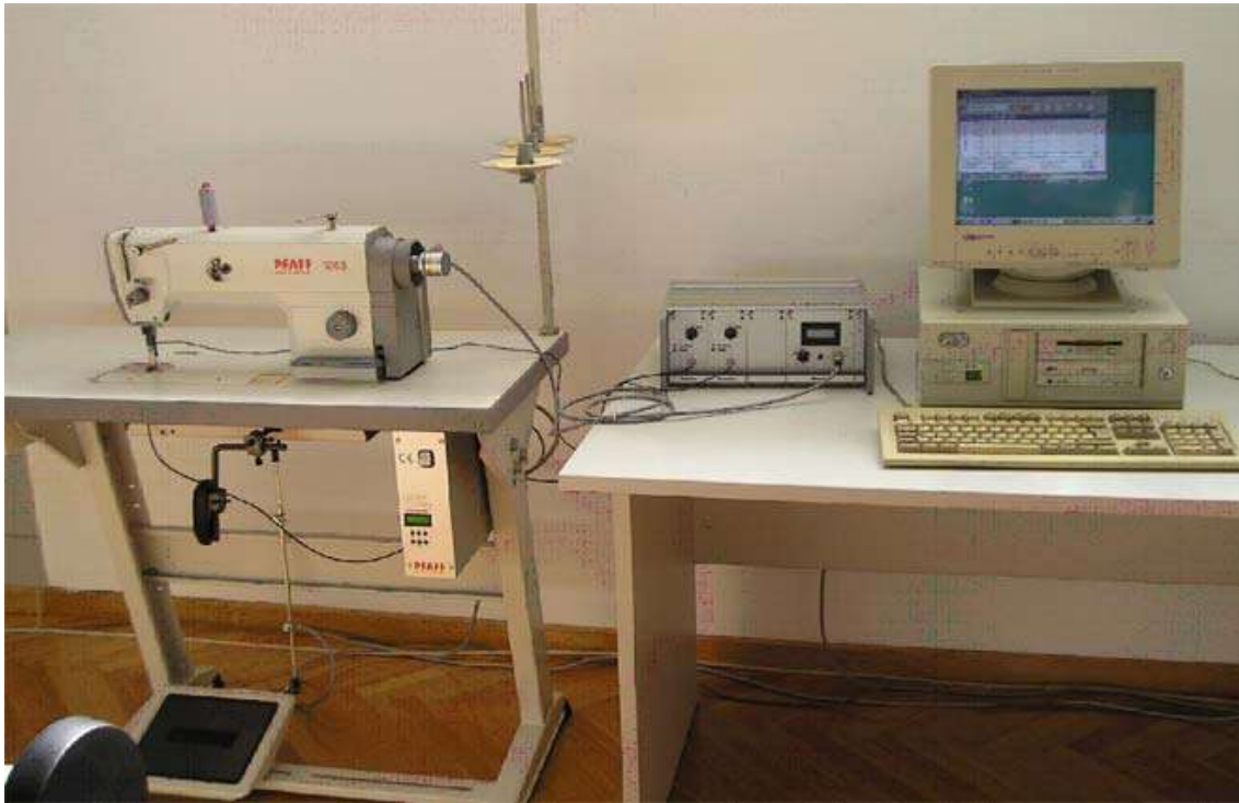
Slika 1: Mjerni sustav za mjerenje probodne sile šivaće igle u Zavodu za odjevnu tehnologiju
