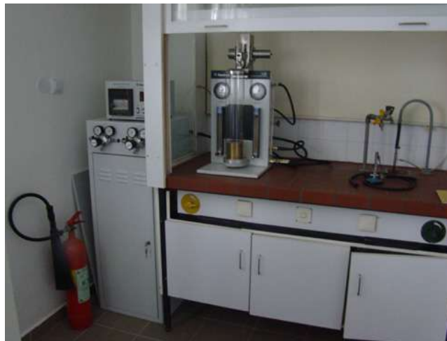
Slika 11: Uređaj za određivanje indeksa kisika na tekstilnim plošnim proizvodima i vlaknima-Low Oxygen Index Chamber
