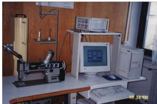
Slika 1: Mjerni sustav za mjerenje dinamičke napetosti konca i probodne sile šivaće igle
