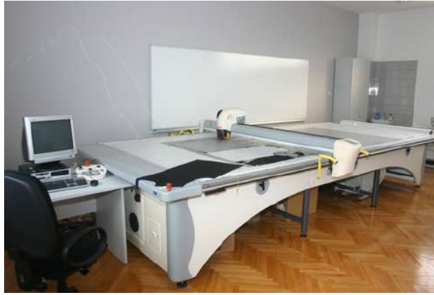
Slika 7: Laboratorij za CAD/CAM sustave odjevnog inženjerstva; agregat za iskrojavanje jednog sloja materijala tt. Lectra Systemes
