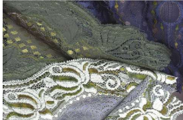
Slika 12: Čipka za donje rublje, stroj Textronic Lace TL 43/1/24, poliamid, poliester, viskoza i lycra
