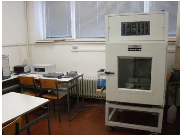
Slika 4: Uređaj za mjerenje otpornosti prolasku topline i vodene pare; Sweating Guarded Hotplate
