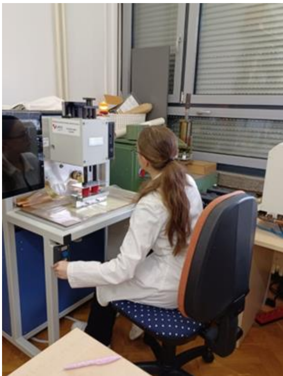
Slika 4. Izrada mjernih uzoraka na stroju ZD-N-4 Depta tvrtke Zemat Technology Group
