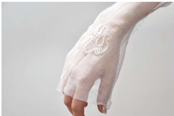
Slika 5. 3D tisak linija različitih duljina i debljina na pamučni tkanini
