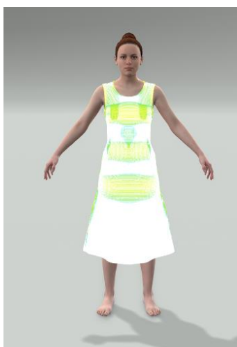
Slika 6: Analiza modela i prikaz mesta koja trpe najveće istezanje materijala (izvor: autor)
