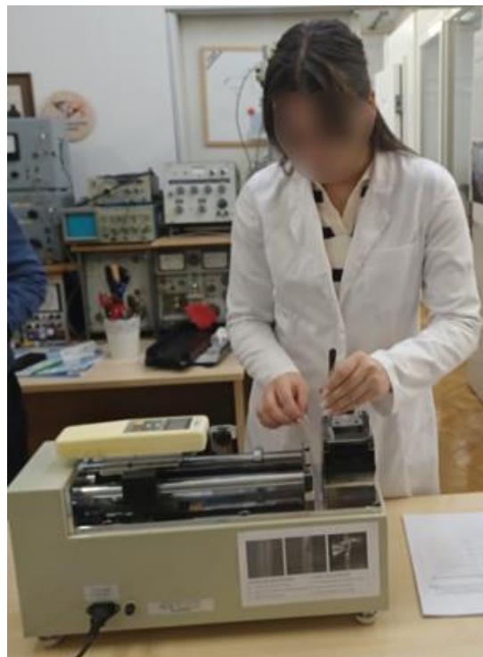
Slika 5. Određivanje prekidnih sila primjenom „T“ ispitne metode kidanja spojeva nastalih visokotehnološkim tehnikama spajanja
