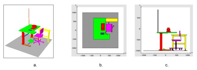
Slika 1: Oblikovano radno mjesto za tehnološku operaciju začvršćivanja šava na rukavima, duljini i ramenici dobiven pomoću modula ERGOMas: 3D prikaz (a), tlocrtni prikaz (b) i bokocrtni prikaz(c).
