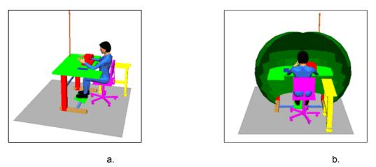
Slika 2: Statička analiza radnog mjesta na oblikovanom radnom mjestu (a) te pripadajućim zonama normalnog i maksimalnog dosega ruku (b)
