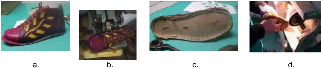
Slika 4: Tehnološke operacije montaže: a. navlačenje gornjišta na temeljnu tabanicu, b. i c. fleksibil izrada, d. brušenje i oblikovanje potplata cipele
