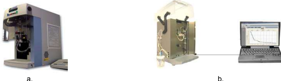
Slika 1: Slike aparata a. TGA, model Pyris 1 TGA, PerkinElmer i b. Elektrokinetični analizator SurPASS
