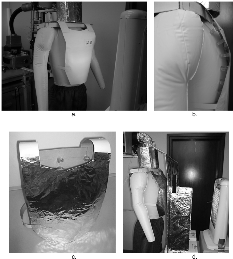
Slika 1: a. prikaz termalnog manekena s prslukom izloženim infracrvenom izvoru zračenja, b. prikaz gumenih prstenova na unutrašnjosti prsluka, c. prikaz prsluka s aluminijskim vanjskim slojem i d. prikaz termalnog manekena s prslukom s aluminijskim vanjskim slojem i aluminijskom konstrukcijom.
