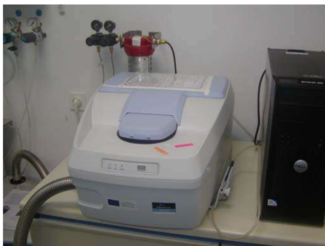
Slika 5: Diferencijalni skenirajući kalorimetar DSC 8000, Perkin Elmer , USA
