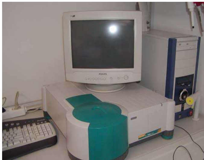
Slika 10: Spektrofotometar Cary 50 Solarscreen, Varian, USA
