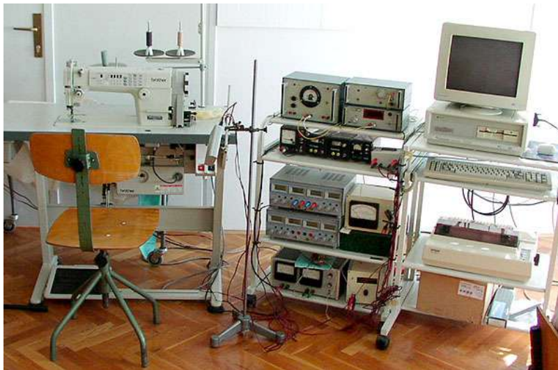
Slika 20: Sustav za automatska mjerenja procesnih parametara i struktura tehnoloških operacija proizvodnje odjeće
