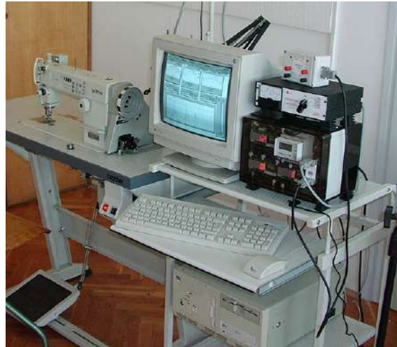
Slika 21: Sustav za mjerenje energetske potrošnje električne energije šivaćih strojeva
