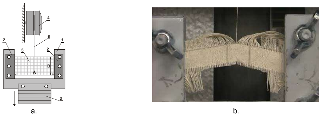
Slika 2: Sklop za ispitivanje sile izvlačenja niti: a) 1 – nosivi okvir; 2 – stezaljke za učvršćenje tkanine; 3 – element za prihvat sklopa u povlačnoj stezaljci; 4 – pneumatska stezaljka s osjetilom sile; 5 – ispitni uzorak tkanine; 6 – nit koja se izvlači; A – duljina uzorka tkanine; B – širina uzorka tkanine, b) uzorak tkanine
