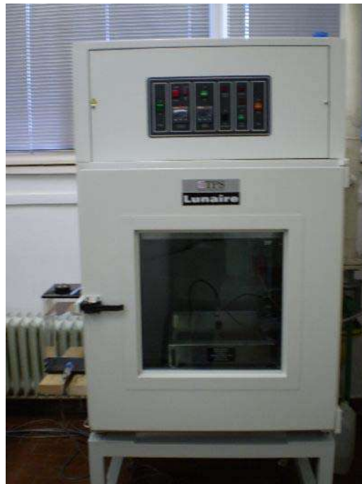
Slika 16: Uređaj za mjerenje toplinske otpornosti i otpornosti prolaza vodene pare
