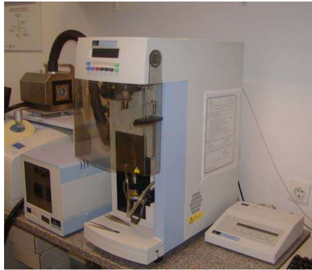
Slika 7: Termogravimetrijski analizator, Pyris 1 TGA, PerkinElmer, USA
