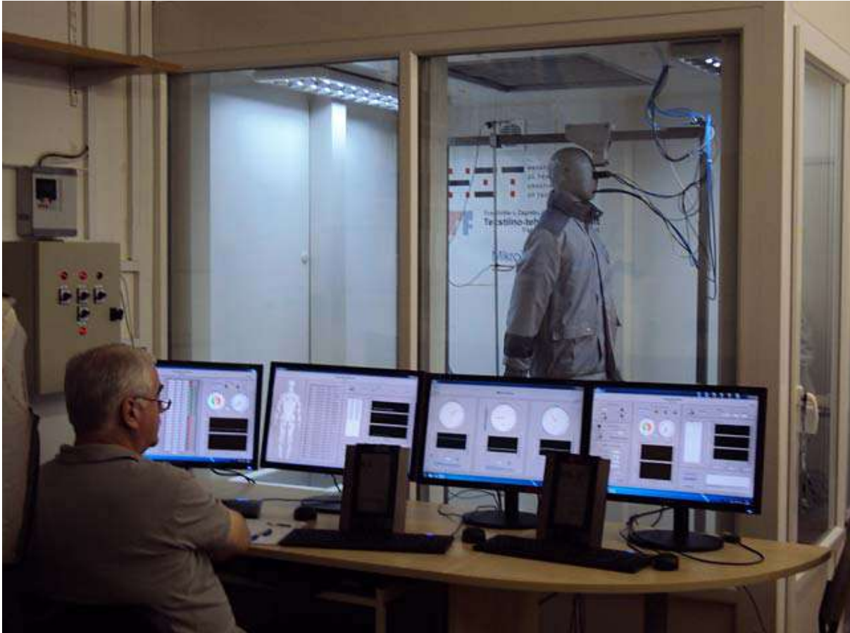
Slika 23: Termalni maneken tijekom ispitivanja inteligentnog odjevnog predmeta s adaptivnim termoizolacijskim svojstvima
