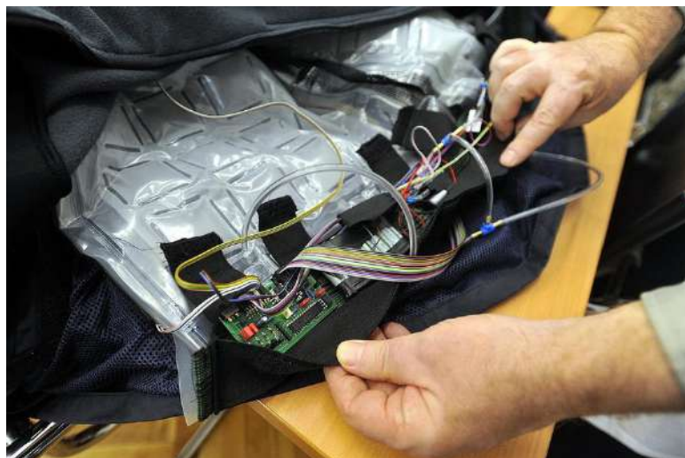
Slika 22: Odjevni predmet s adaptivnim termoizolacijskim svojstvima (detalj elektroničke)
