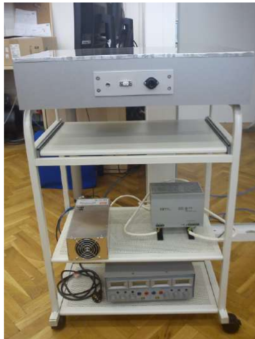
Slika 25: Sustav za određivanje toplinskih svojstava materijala i kompozita ugrađenih u odjeću
