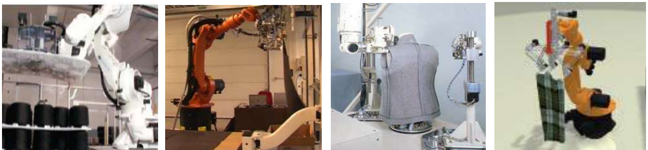
Slika 4: Primjena industrijski robota u procesu sortiranja prediva i konfekciji odjevne tehnologije [10,11]
