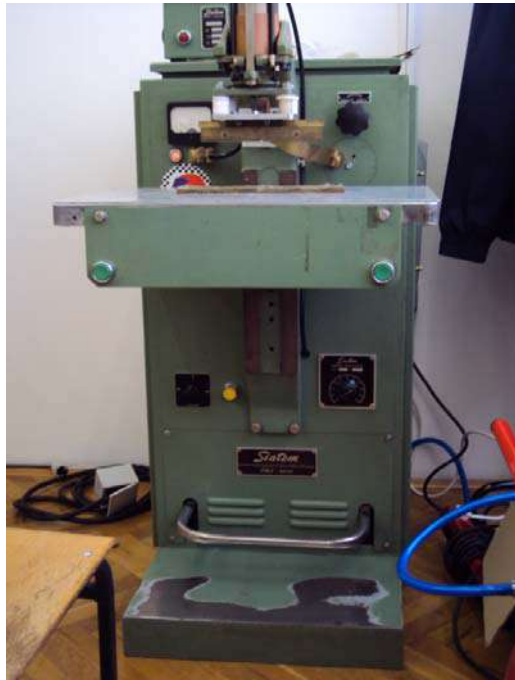
Slika 29: Specijalni stroj za visokofrekventno spajanje tt. Siatem,
