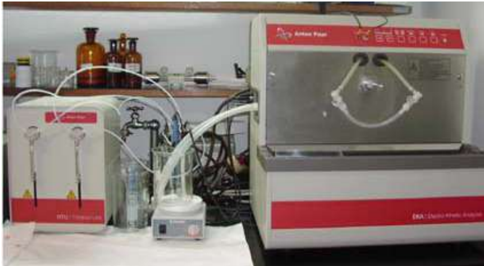
Slika 9: Elektrokinetički analizator (Electro Kinetic Analyzer), Anton Paar, Austria
