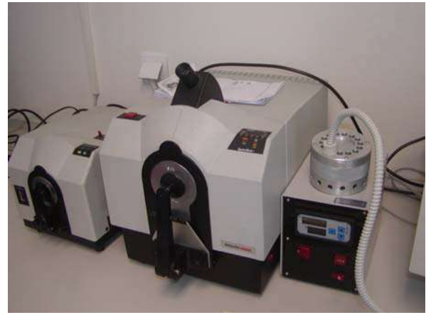
Slika 11: Remisijski spektrofotometar Spectraflash: SF 600+CV UV, SF 300 Plus -CT Datacolor, CH
