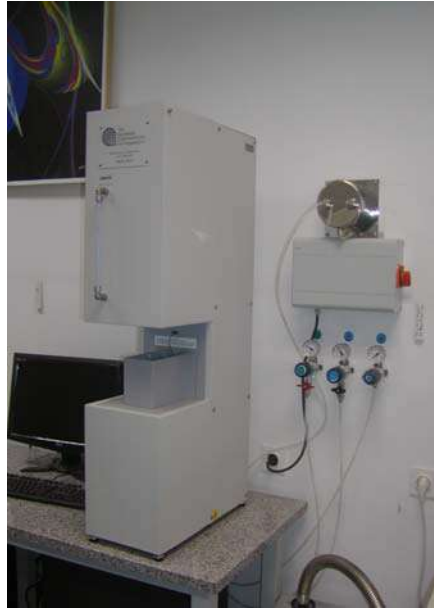
Slika 13: Mikrokolorimetar za sagorijevanje (Microscale combustion calorimetry MCC), UK
