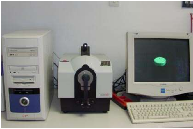
Slika 11: Remisijski spektrofotometar Spectraflash: SF 600+CV UV, SF 300 Plus -CT Datacolor, CH
