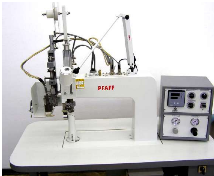
Slika 28: Specijalni stroj za toplotno spajanje oznake 8304-020 tt. PFAFF
