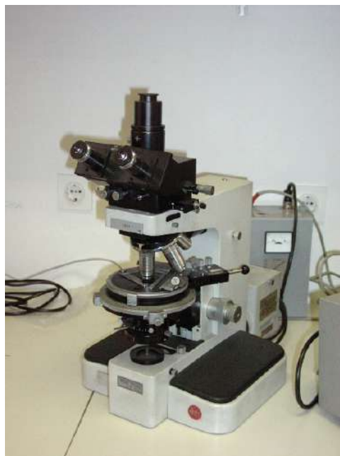
Slika 4: Polarizacijski mikroskop ORTHOPLAN-pol - tt. Leitz, D
