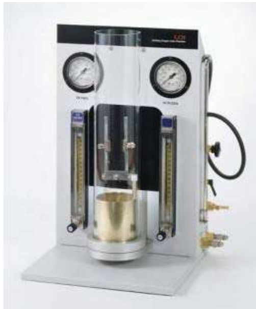
Slika 12: Granični indeks kisika (Limited Oxygen Indeks) LOI, Dynisco, USA
