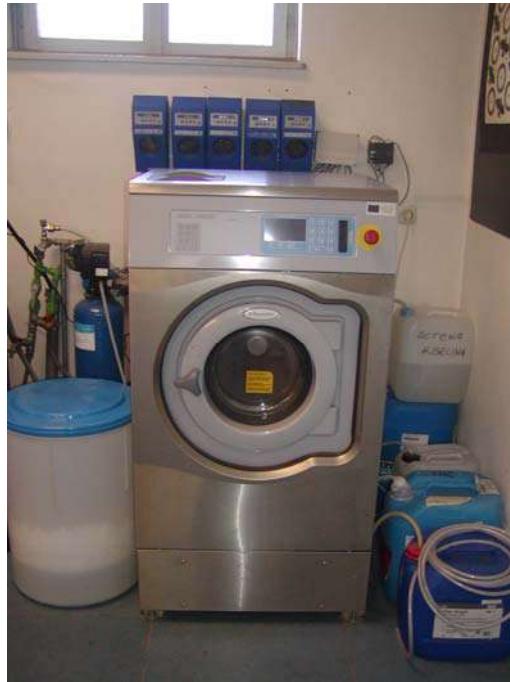
Slika 17: Laboratorijska perilica Wascator FOM71 Electrolux CLS, S
