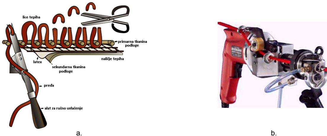
Slika 1: Ručna izrada tafting tepiha: a) shematski prikaz, b) elektropneumatski alat – "pištolj"
