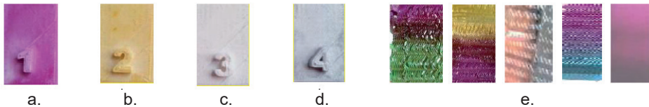
Slika 2: Obojani 3D uzorci postupkom iscrpljenja: a) disperznim bojilom, b) kiselim bojilom, c) reaktivnim bojilom, d) baznim bojilom i e) ombre efekti
