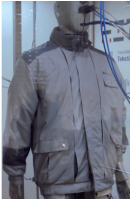
Slika 1: Inteligentni odjevni predmet na termalnom manekenu
