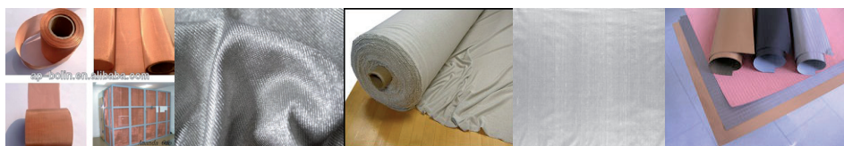
Slika 1: Međupodstavni materijali s metalnim nanosima za zaštitu od EM zračenja [8]
