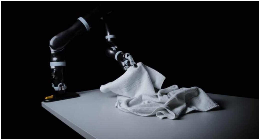
Slika 4: Sewtsov robot, dizajniran za obavljanje naprednog rukovanja tekstilom za različite zadatke
