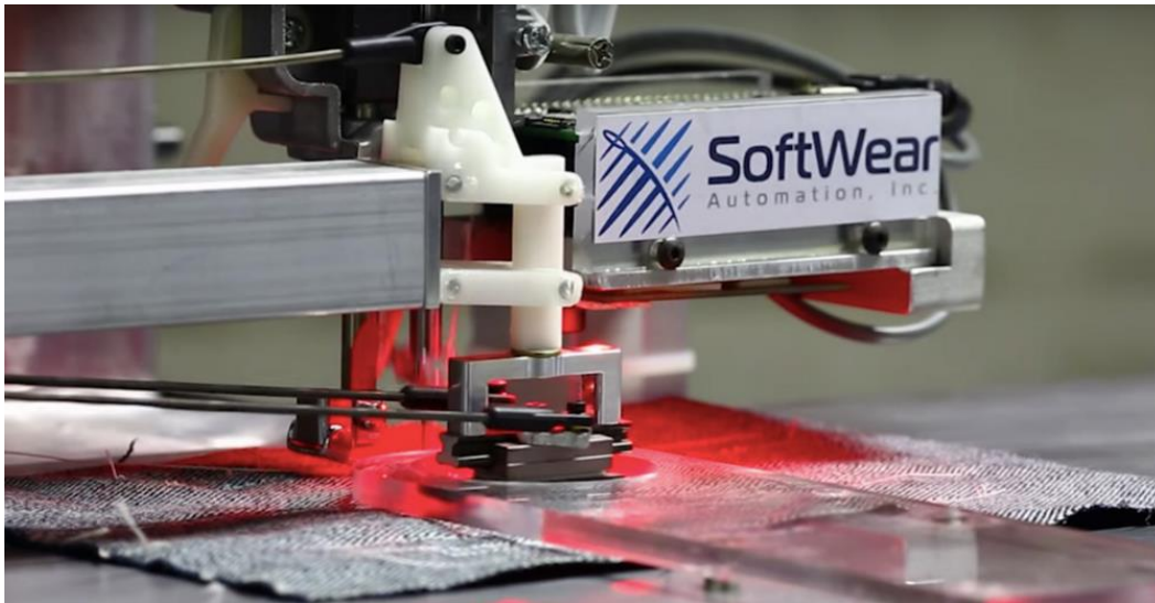
Slika 3: SoftWearov robot za šivanje koji može rukovati tkaninom, pravilno je postaviti i izvesti šivanje.
