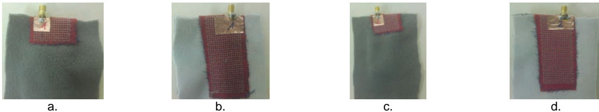
Slika 4: Konstrukcije tekstilnih PIFA antena na različitim podlogama: a) i b) na filcu; c) i d) na pamučnoj podlozi
