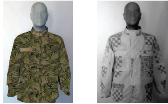
Slika 5: Prikaz vojne uniforme sa skrivenom porukom: a. prikaz u VIS području (maskirni uzorak); b. prikaz u NIR području na 1000 nm valne dužine (vidi se skrivena poruka nevidljiva oku u VIS području).
