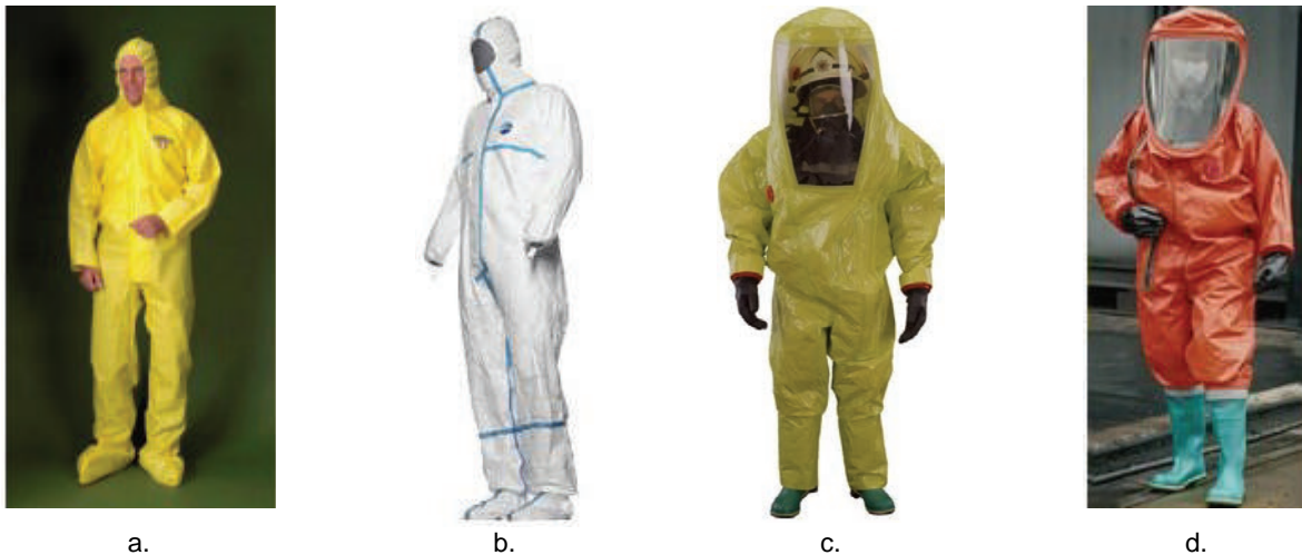
Slika 1: Primjeri kemijske zaštitne odjeće s obzirom na trajnost uporabe: a. plinonepropusni jednokratni kombinezon; b. Tyvek® jednokratni kombinezon; c. plinonepropusno odijelo ograničene upotrebe, tip 1A izrađeno od Tychem materijala; d. plinonepropusno trajno odijelo tip 1A izrađeno od materijala Viton/Butyl/Viton ili Viton Laminat [4].
