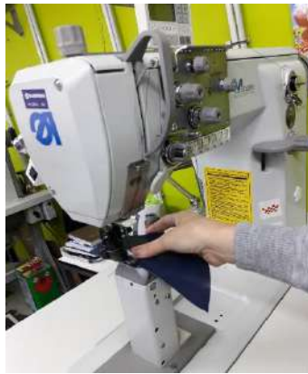
Slika 8: Šivanje dijelova gornjišta
