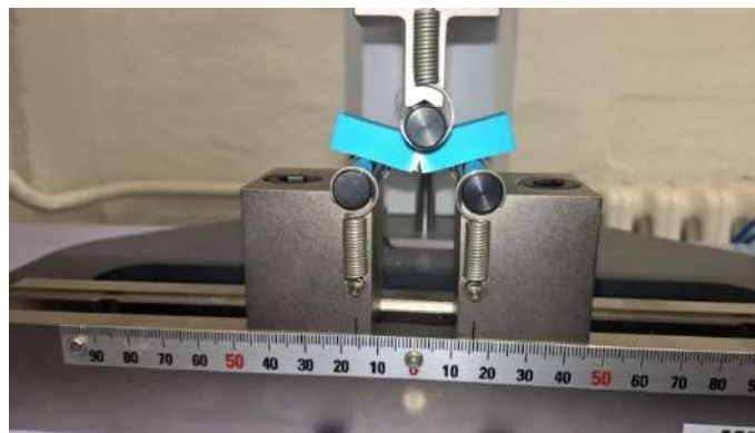
Slika 7: Ispitivanje savojne čvrstoće tijekom pretpokusa [3]
