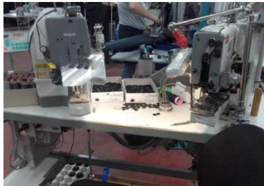
Slika 5: Radno mjesto za izradu tehnološke operacije našivanja gumba na muškim hlačama [3]
