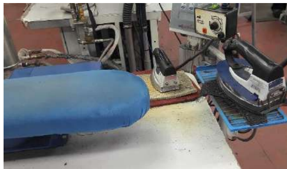
Slika 4: Stol za glačanje s parnim glačalom za lijepljenje trake na duljini muških hlača [3]
