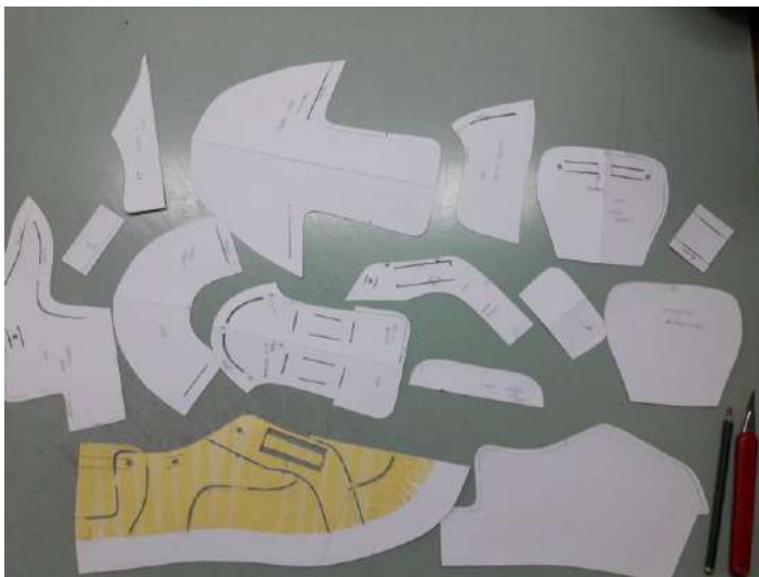
Slika 5: Šablone krojnih dijelova gornjišta cipela
