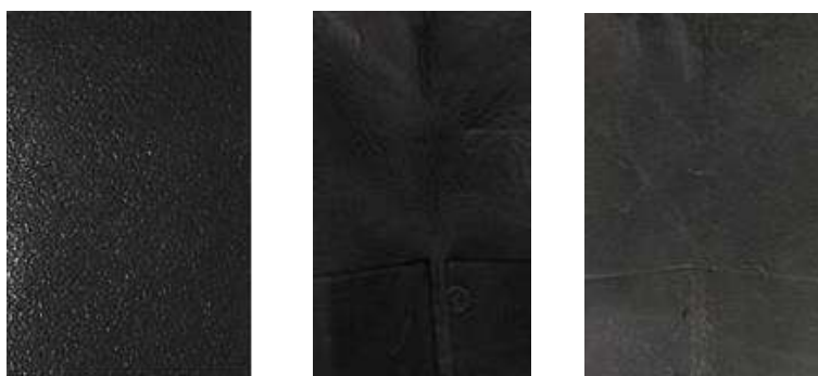
Slika 1: Uzorak GK1 a. prije ispitivanja, b. nakon 50000 ciklusa suhog savijanja, c. nakon 25000 ciklusa mokrog savijanja
