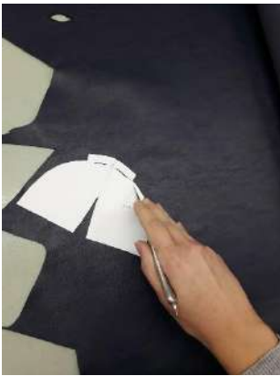
Slika 7: Označavanje šablona krojnih dijelova gornjišta cipel
