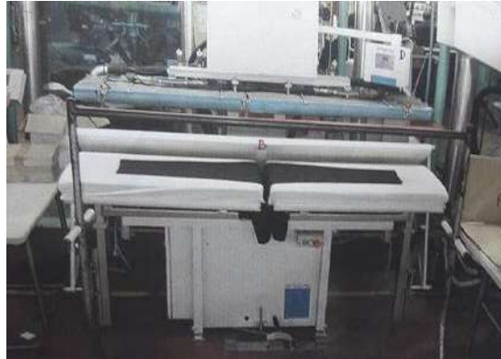
Slika 1: Preklopna preše tt. Brisay, tip BRI-222 /101 za glačanje nogavica muških hlača [3]
