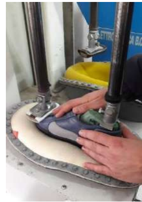
Slika 10: Učvršćivanje spoja gornjišta i đona pod prešom
