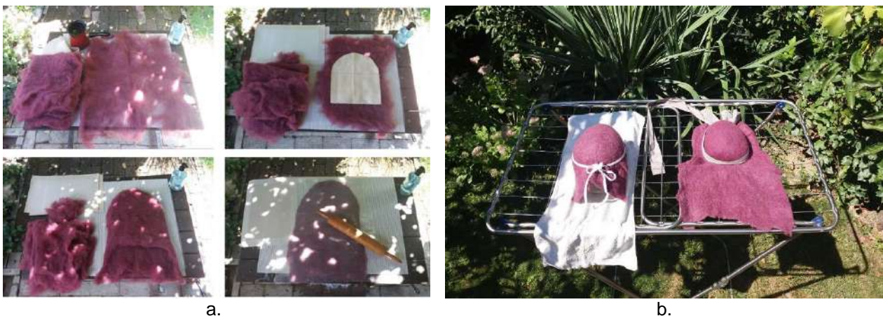
Slika 2: Izrada filcanog šešira; a. - Proces filcanja vune; b. - Sušenje filcane vune na kalupima
