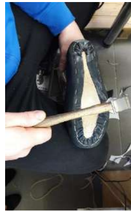
Slika 9: Gornjište navučeno na kalup
