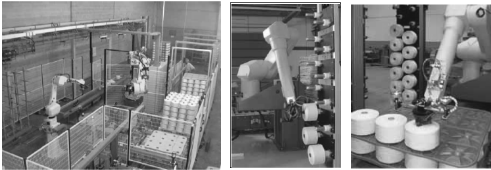
Slika 3: Roboti za rukovanje namotcima
