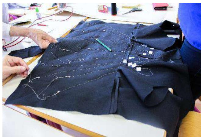
Slika 2: Izrada prototipa ovratnika i slaganje mreže za LED diode
