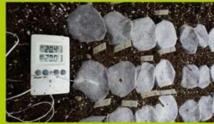
Površinske mase uzoraka kreću se u rasponu od 17,22 g/m<sup>2</sup> do 50,33 g/m<sup>2</sup> (Tablica 1). Površinska masa uzoraka ima mali koeficijent varijacije, odnosno uzorci su relativno jednolični po masi. Prosječne debljine agrotekstila kreću se od 0,17 mm do 0,35 mm. Najmanju debljinu ima uzorak B najmanje površinske mase (17,22 g/m<sup>2</sup>). Koeficijenti varijacije debljine su u rasponu od 0,02% do 11,18%.
