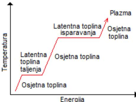
**Slika 1:** Oblici topline tijekom promjene agregatnog stanja PCM materijala [3]
