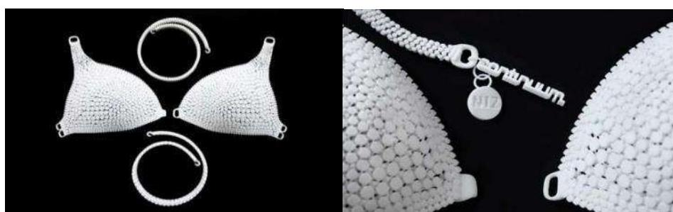
Slika 3: Bikini načinjen selektivnim laserskim srašćivanjem [5]
