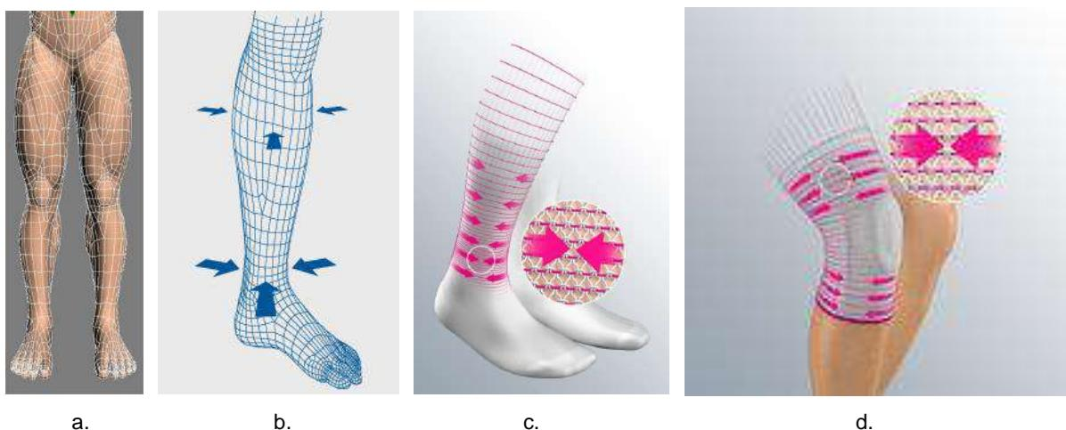
**Slika 3:** Načelo analize noge pri projektiranju parametara strukture čarape: a) računalno skenirane ljudske noge, b) mrežni poligoni na nogi značajni za konstrukciju čarape, c) modeliranje pritiska čarape na potkoljenični mišić i d) modeliranje pritiska steznika na koljeno
