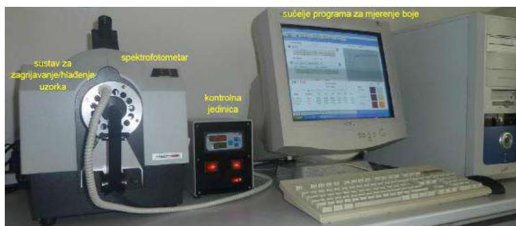
**Slika 3:** Sustav za zagrijavanje/hlađenje uzoraka na spektrofotometru
