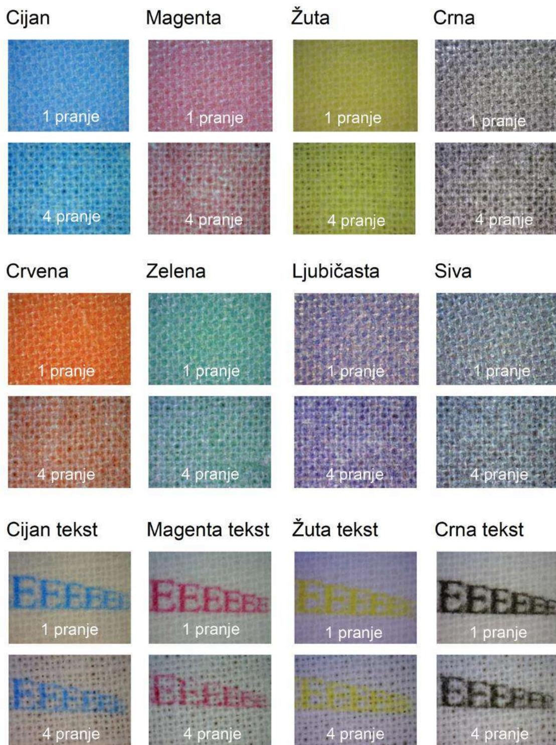
Slika 5: Mikroskopske fotografije (uvećane 50x) direktnih otisaka punih tonova bez pranja i nakon 4 pranja
