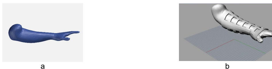
Slika 1: 3D modeli: a) podlaktice dobiven digitalizacijom nakon postupka 3D skeniranja, b) ortoze dobiven primjenom programa za 3D modeliranje, te predstavljen u odnosu na model podlaktice
