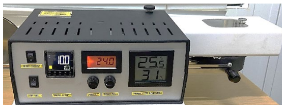
Slika 1: Uređaj za nedestruktivno mjerenje otpora prolazu vodene pare, Permetest
