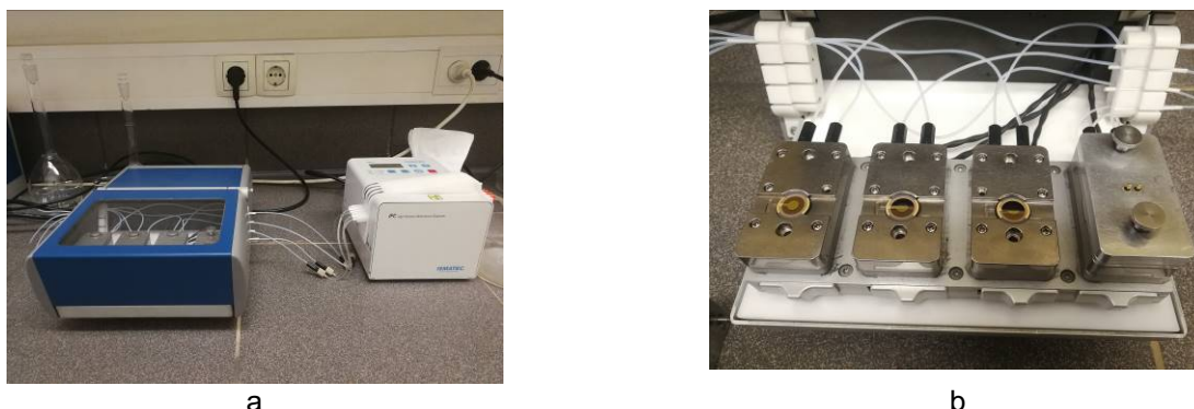
Slika 2: Mjerni sustav kvarc-kristalne mikrovage s praćenjem disipacije: a) QCM-D b) kućište za kvarcne senzore s celuloznim polimernim filmom (MCF).
